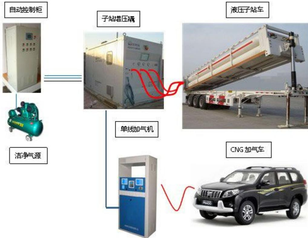
图2 加气工艺流程图
